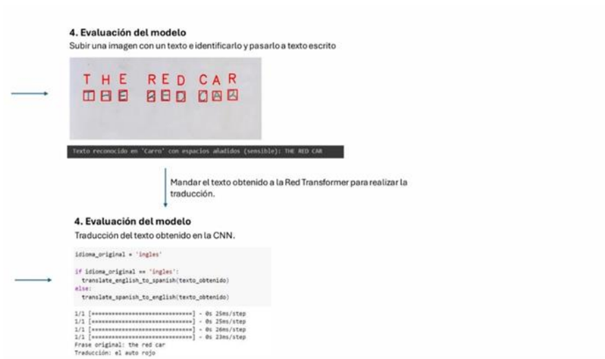
Fig. 2. Evaluación de los modelos, el producto de uno (CNN) siendo el input del otro (Red Transformer).
