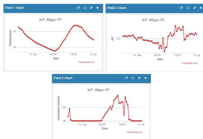
Fig. 2. Visualización interfaz gráfica remota de 24 horas en ThingSpeak de 1) Temperatura, 2) pH 3) intensidad lumínica, del sistema de invernadero con cubierta blanca al 50%. (ThingSpeak.com).
