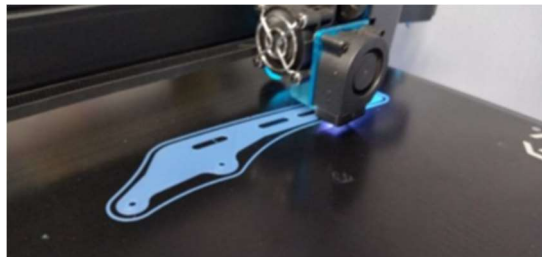
Fig. 3. Impresión de piezas mediante la impresora Artillery SideWinder X1.
