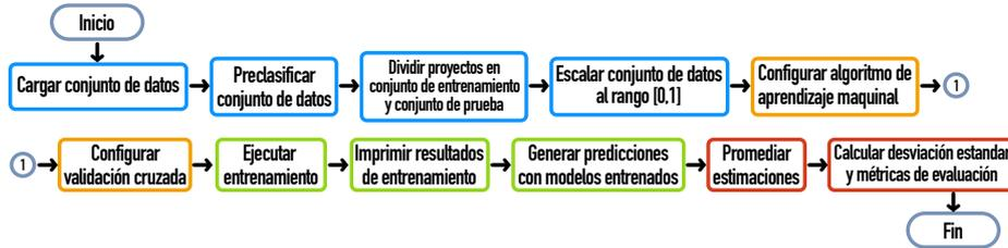
Fig. 3. Diagrama de flujo de los experimentos.
