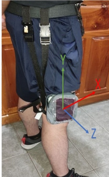
Fig. 2. Disposición del teléfono inteligente y correspondencia entre los ejes anatómicos del sujeto y del giroscopio del teléfono.
