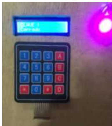
Fig. 7. Prototipo en estado cerrado indicado mediante la LCD y el led encendido de color morado encendido.
