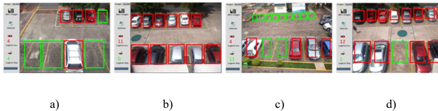
Fig. 9. Resultados de la implementación del algoritmo propuesto en la tarjeta Raspberry pi 4.
