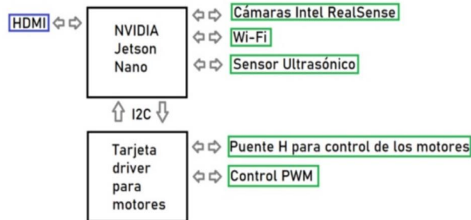
Fig. 1. Diagrama a bloques de la integración de los componentes.
