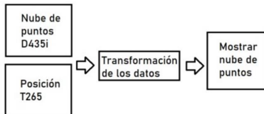
Fig. 2. Diagrama a bloques de la transformación de los datos recolectados por las cámaras.
