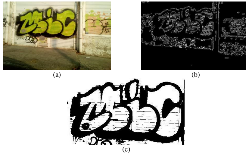
Fig. 7. Proceso para la obtención de grafitis. En (a) imagen Binaria de origen. En (b) filtro Sobel aplicado. En (c) recorte de la imagen por etiquetado de regiones.
