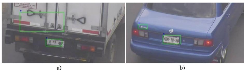
**Fig. 6.** Detección de placas en imágenes con vista lateral izquierda.
