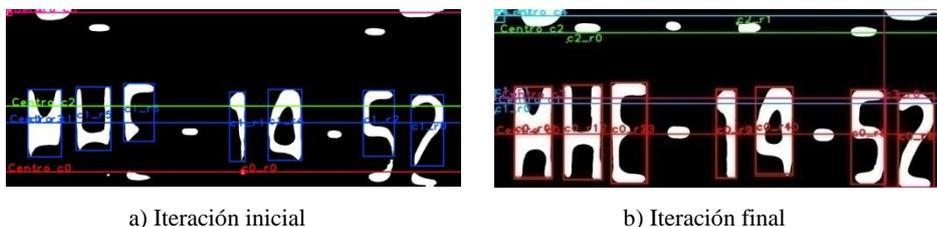
Fig. 10. Segmentación aplicando clustering y rango de color.
