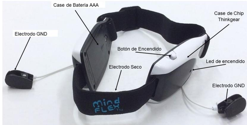
**Fig. 2.** Diagrama de los componentes de la Diadema Mindflex.
