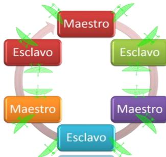
Fig. 1. Topología de anillo redundante.
