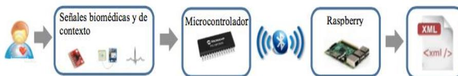
Fig. 3. Adquisición y procesamiento de la señal.
