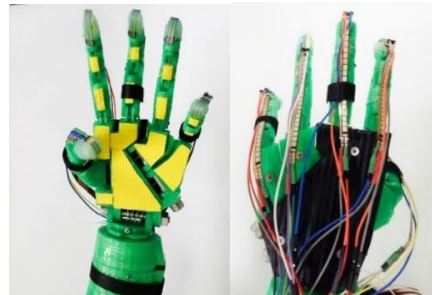
Fig. 5. Mano Robótica con sensores de presión y flexión instalados en el anverso y reverso.
