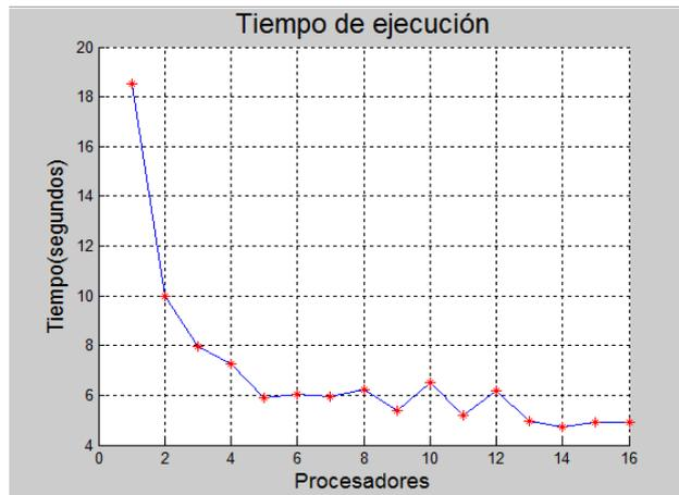
Fig. 2. Tiempos de ejecución del algoritmo genético paralelo para el problema tsplib\_problem\_d1291.
