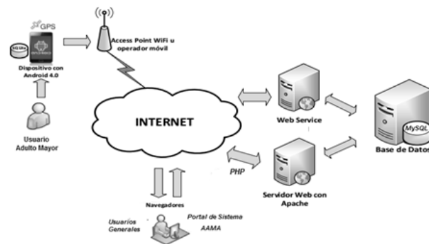
Fig. 4. Esquema de la arquitectura de la Aplicación TENAMIKI.
