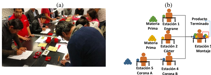
Fig. 1. (a) Taller de simulación kanban. (b) Proceso de ensamble del reductor.
