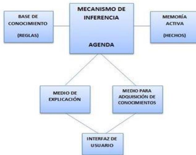
Fig. 1. Elementos de un sistema experto [9].
