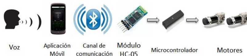
Fig. 4. Elementos de la comunicación entre el módulo bluetooth y la aplicación móvil.
