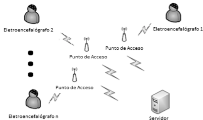
Fig. 1. Diagrama del sistema mHealth para la adquisición de la señal EEG
