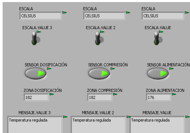
Fig. 5. Simulación de temperaturas de Extrusión en LabView.
